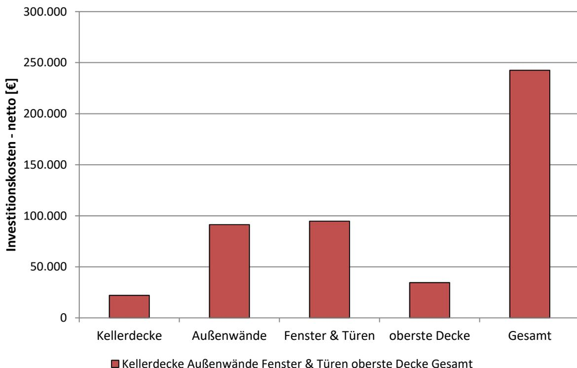
Abbildung 7: Investitionskosten der einzelnen Sanierungsmaßnahmen
