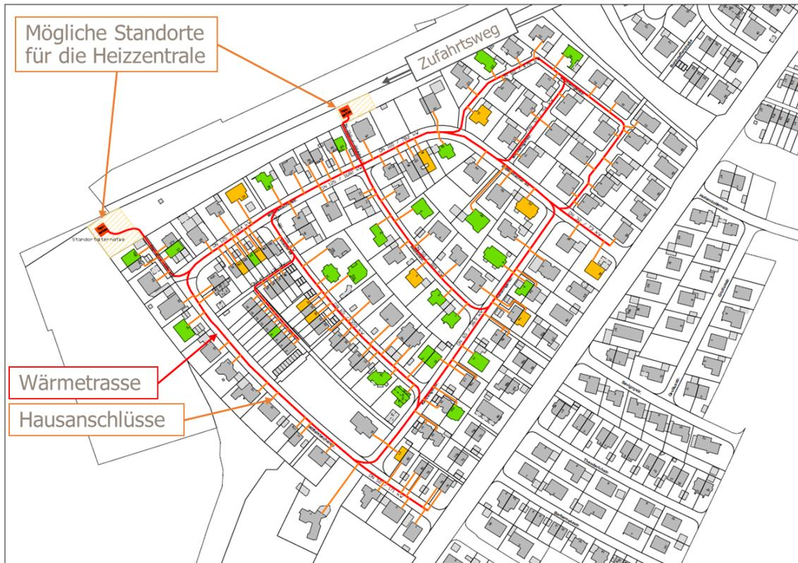
**Abbildung 5: Möglicher Trassenverlauf mit potenziellen Standorten für eine Heizzentrale [Quelle: Stadt Ingolstadt; Bearbeitung: IfE GmbH]**
